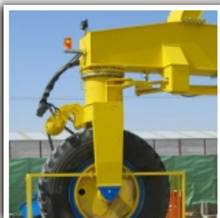
DIRECCIÓN ROBUSTA PROPORCIONAL AL RADIO DE GIRO
