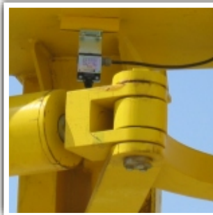
ALINEACIÓN AUTOMÁTICA DE DIRECCIÓN
