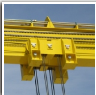
CARRO DESPLAZADOR CON LIMITADOR DE CARGA SUMATORIO DE PESAJE
