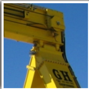
ESTRUCTURA CON UNIÓN ARTICULADA
